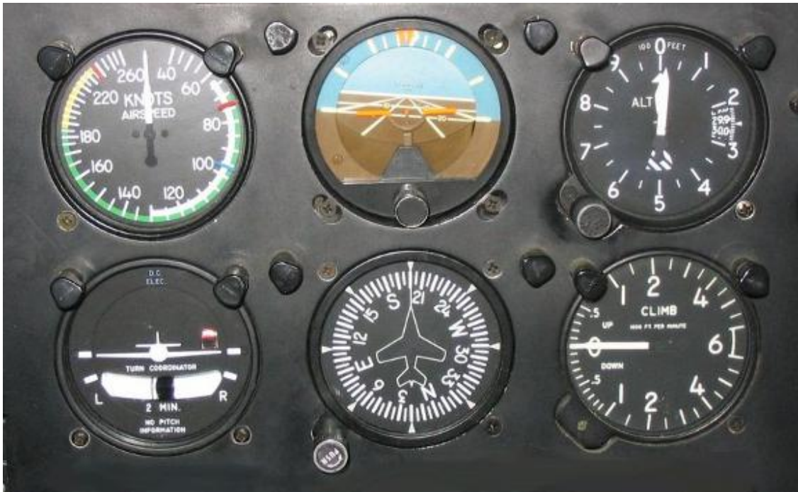
Figure 6 Typische cockpitinstrumenten en -layout
